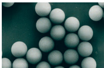
图29 配基通过不带电荷、化学稳定的氧-醚键偶联到均一的SOURCE颗粒上。
